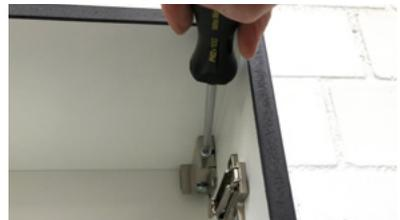
Fixieren Sie den Schrank, indem Sie die Frontschraube nun im Uhrzeigersinn drehen.
