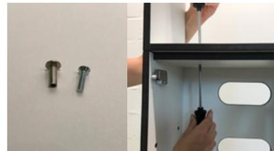
Drücken Sie die Schrauben von oben durch die Löcher und kontern Sie diese mit den Hülsenschrauben.
