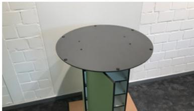
Legen Sie die Bodenplatte auf das Bottom Modul. Richten Sie es so aus, das die Positionen der Bohrungen übereinstimmen.
