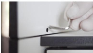
Nutzen Sie den Sechskantschlüssel, um die Beschläge in allen vier Ecken zu arretieren...
